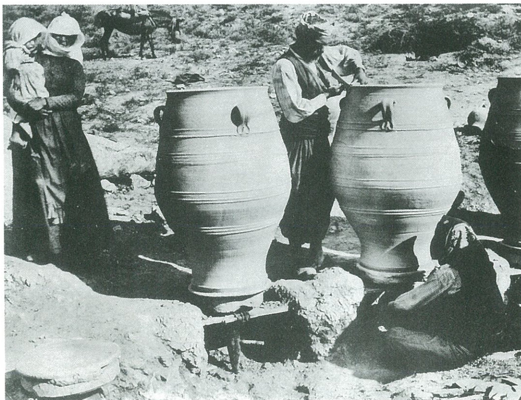
Fig. 2 - Creta. Un vasaio modella con la tecnica del colombino un enorme pithos, utilizzando un tornio primitivo messo in movimento da un aiutante (foto dell'inizio del secolo, Bosanquet Archive, British School at Athens).
