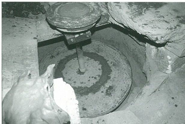
Fig. 12 - Grottaglie, tornio a piede detto "rota di lu capasunaru" usato per la modellazione dei grandi anforoni detti "capasuni".
